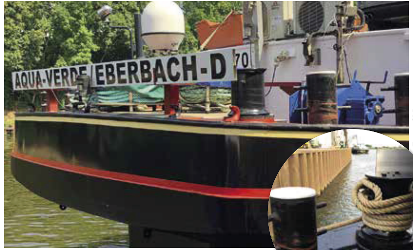
Die Poller-Spillwinde befindet sich am Heck des Schiffes
